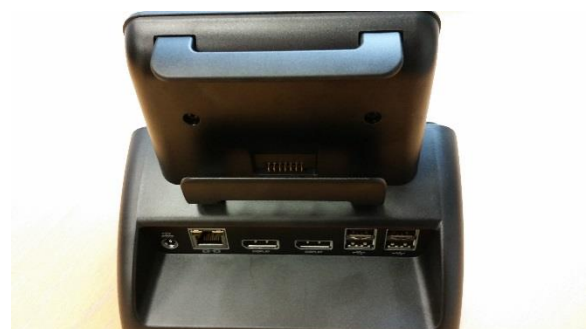
Rückseite, aktive Dockingstation, Schnittstellen
